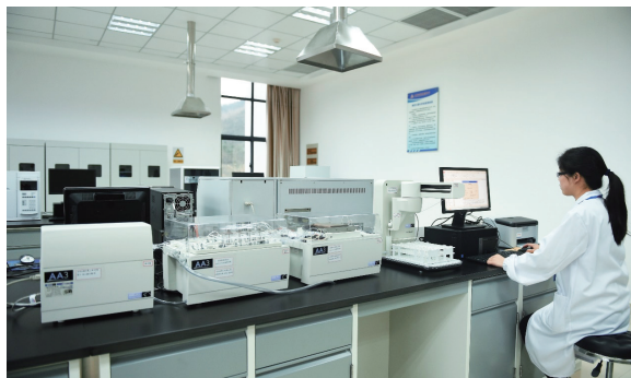
实验室人员在司尔特测土配方施肥研究基地操作氮、磷、钾流动分析仪
